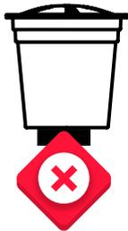
El área de la superficie sobre la cual se instalará el tanque siempre debe ser mayor que el área del fondo del tanque.
