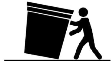
El desplazamiento del tanque debe hacerse girándolo sobre el borde de la arista inferior.
