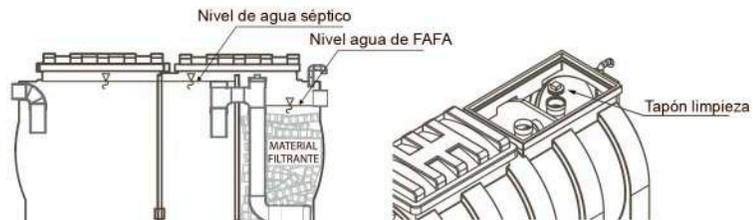
Si el nivel del agua en el tanque séptico esta por encima de lo normal y fluye lento hacia el FAFA significa que el filtro esta taponado y requiere mantenimiento.
