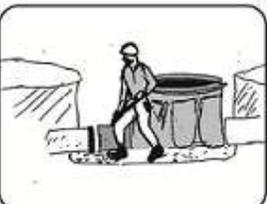
5 Ensamblar la salida del MH a la tubería de salida.
