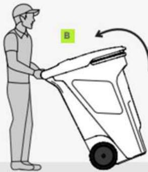
Apoye el pie en el eje de las ruedas para inclinarlo hacia atrás (figura B)
